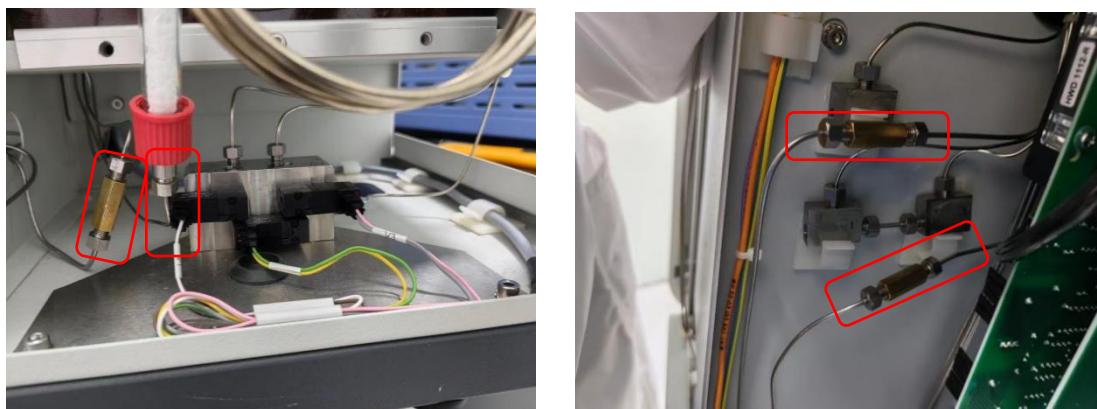
图 3 改装载气节省模式线路图
