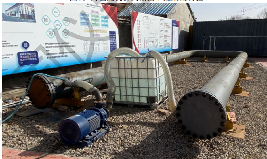
图20 内检测机器人水推数据采集实验
