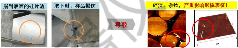
图 1 样品拆卸已造成损坏，影响 AFM 形貌表征
