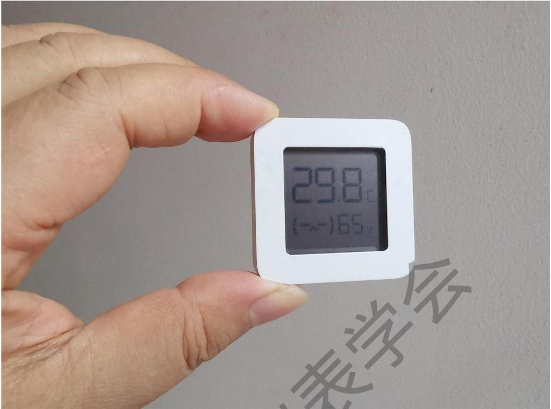
小米蓝牙温湿度计 2 是一款智能互联产品。体积小（4.3X4.3X1.25 厘米），重量轻（仅仅 12 克），使用瑞士盛思锐（Sensirion）公司新一代数字温湿度传感器，测量范围：温度 0~60°C，分辨率 0.1°C；湿度 0~99%RH，分辨率 1%RH。使用一颗 CR2032 锂纽扣电池。温湿度测量准确度高，稳定性好。
