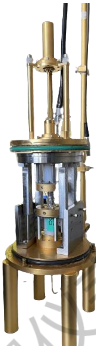
图 4 同轴微量热计镜像对称定标结构
