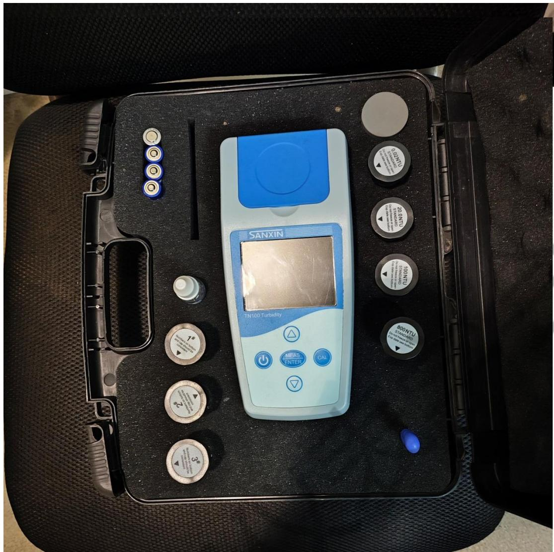
该款仪器外形美观，有一个彩色的大显示屏，测量模式背景显示蓝色，校准模式背景显示绿色，看起来非常清晰、舒适。面板上有操作按键，只有五个键，操作很简单，能实现所有功能。测量准确度很高，低浓度差不多 2%以内，高浓度差不多 1%以内。重复性也很好，一般都在 1%以内。
