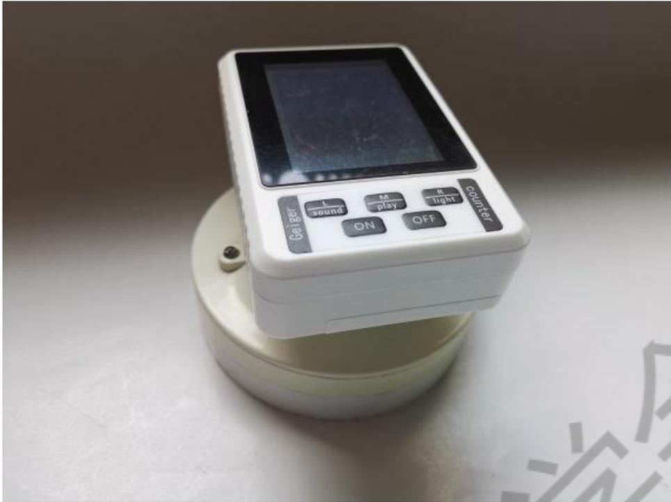
观察到瞬时最大值  $0.35\mu\text{Sv/h}$ ，平均值  $0.23\mu\text{Sv/h}$ ：
