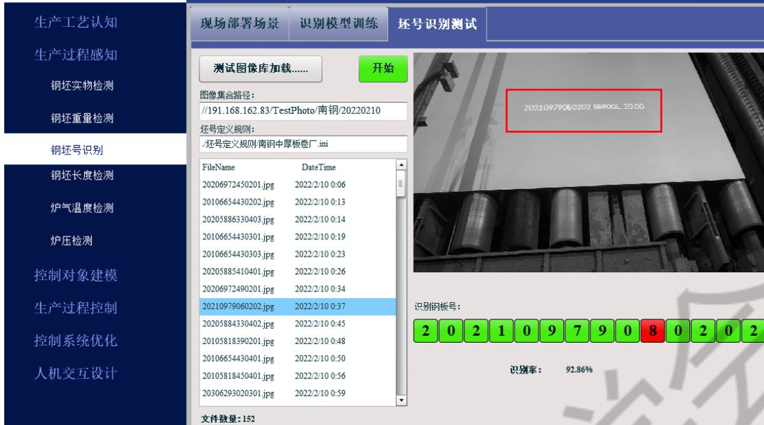
图 7 DNN 坯号识别测试
