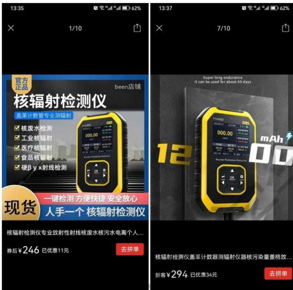
至此，我们看清了这类红绿灯（红蓝灯）“核辐射检测仪”的真相，是完完全全的假货！没有任何核辐射检测功能。硬要说有检测功能的话，那就是检测家里的市电插座有没有电的验电器。
