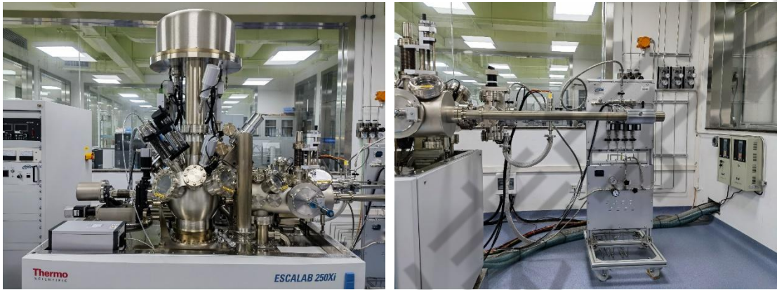
图 1 广东工业大学分析测试中心 XPS 原位光照系统与准原位高温气体反应系统
