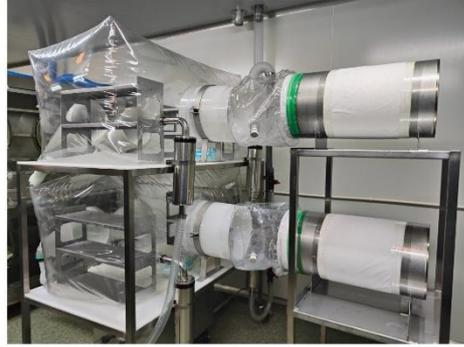
图1 (A) 灭菌缸 (B) 无菌软包隔离器
