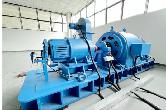
图8 模拟水轮发电机组
