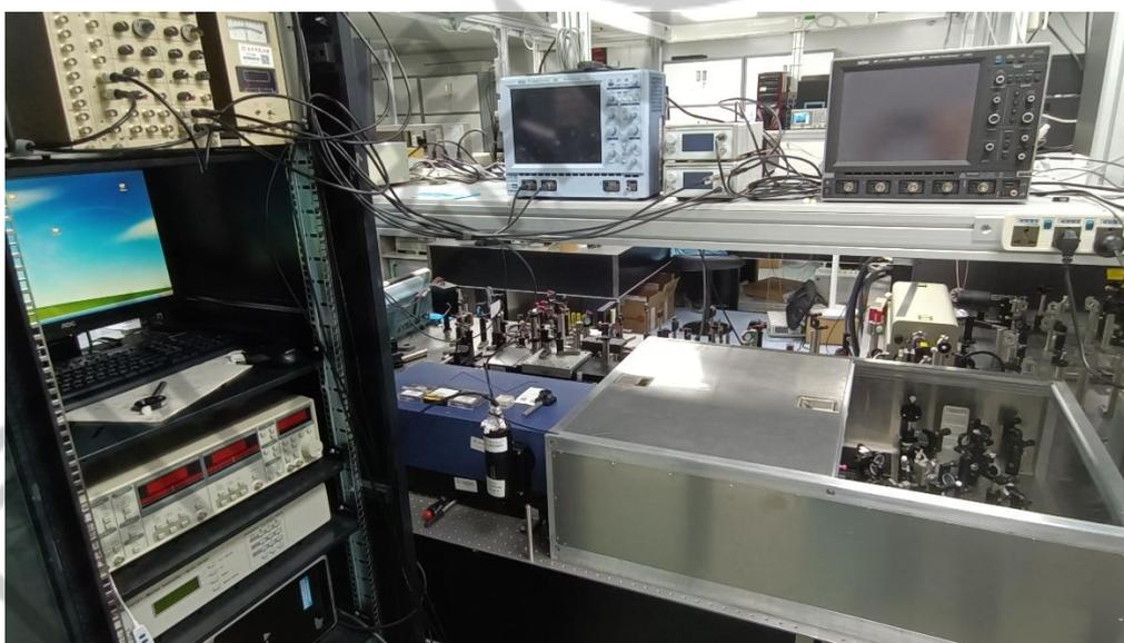
图 4 飞秒-微秒时间分辨圆偏振发射光谱仪装置图
